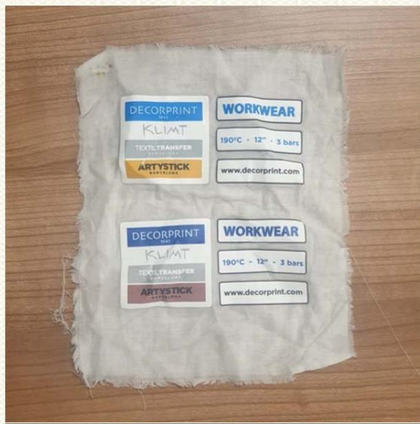
En el lavado acuoso se ha partido de la base de que en los ciclos de lavado se han reproducido las condiciones de temperatura y programa de lavado que suelen utilizar las lavanderías industriales.
